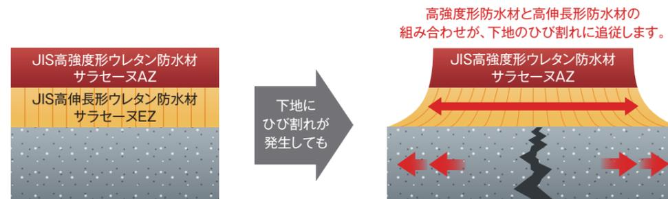
既存ウレタン防水層の塗り重ねにおいても高強度形防水材料を使用することで同様の防水層を形成できます。(イメージ図)
