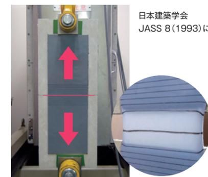
堅鎧工法は、補強布なしでも、X-2相当工法以上の性能を有していると言えます。
