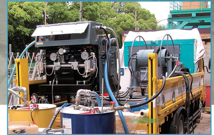
ポリウレア樹脂 スプレー施工システム車両 (例) (ホース延長90m)
